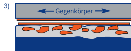
Bildung des Transferfilms - Aufbau eines Schmierstofffilms zw. den Reibpartnern.
