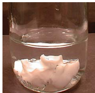
Krytox™-Fett löst sich in einem Kohlenwasserstofflösemittel nicht auf.
