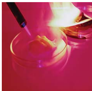
Kohlenwasserstoff-Schmiermittel brennen; Krytox™-Produkte brennen nicht.
