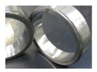
DIN 51802, 7 Tage, destilliertes Wasser **Keine Korrosion**
